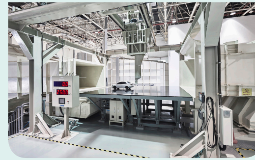
• 1/4 风洞试验室： 验证汽车的空气动力性能，设计出环保节能、行驶性能卓越的造型。 • 新能源试验室： 引入电驱动系统技术，并导入测功机、排放分析仪、加振台等一系列开发测试设备。
