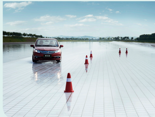
• 低摩擦路： 面积为全国最大，能模仿冰面、雪面等湿滑路。
