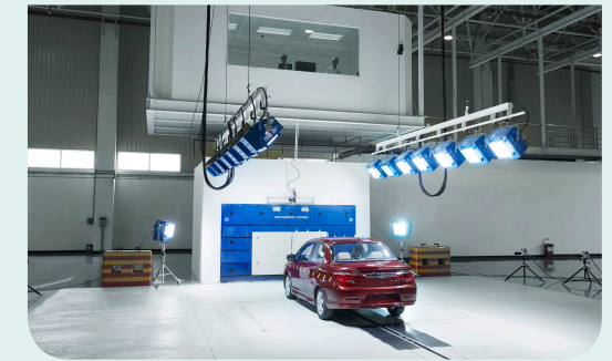
• 碰撞试验室： 可反复进行正面碰撞、偏置碰撞、侧面碰撞等各种形式的碰撞试验。
