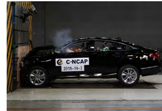
第十代雅阁 (ACCORD) 正面 100% 重叠刚性壁障碰撞试验
