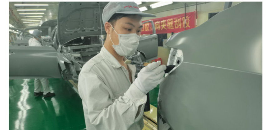
尾灯夹缝密封胶修整作业
