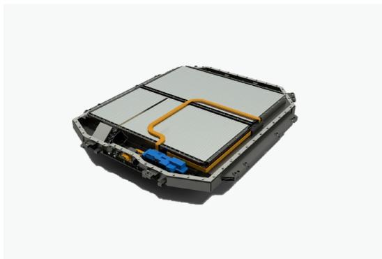
磷酸铁锂刀片电芯无模组电池包
