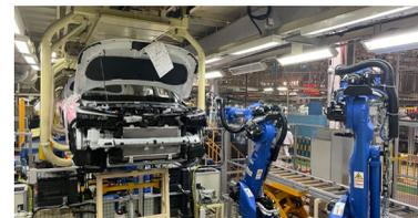
整车前端模块装配自动化生产线
