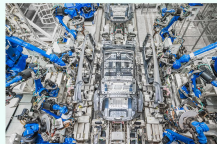
焊接车间大规模应用高速机器人
